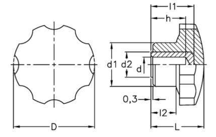
$\begin{array}{ll} D & = 54 \\ d1 & = 24 \\ d2 & = 16 \\ d & H9 = 10 \\ h & = 21 \\ L & = 32 \\ l1 & = 25 \\ l2 & = 13 \\ \end{array}$
